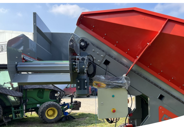
ÉBRANCHEUR ROULEAU ET COFFRET ÉLECTRIQUE
